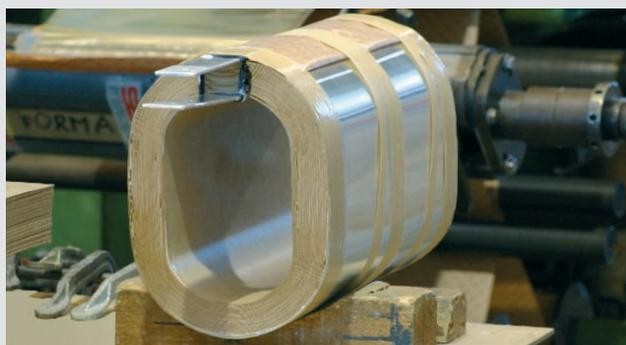
способную противостоять тяжелым электродинамическим усилиям, возникающим при КЗ.
